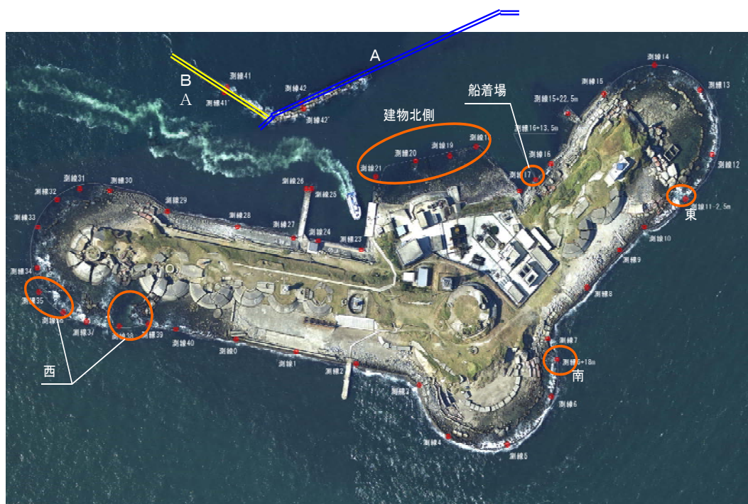
写真-3.2.5 第二海堡護岸の崩壊箇所と調査地点
