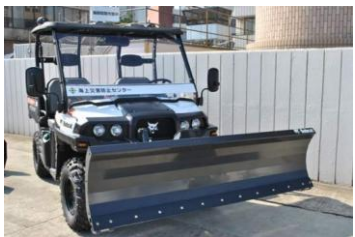
海岸防除作業車両
