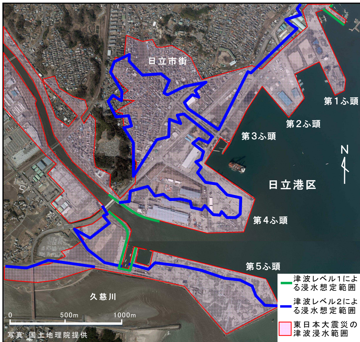
図-6 茨城港日立港区の津波レベル毎の浸水状況
