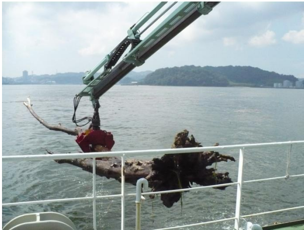
流木回収状況 (べいくりんによる回収)
