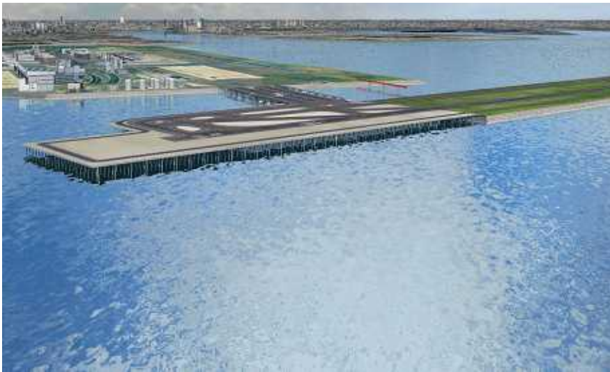
図1. 多摩川の通水性を確保するため栈橋形式
