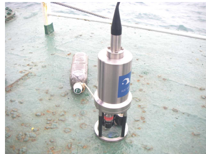
多項目水質計（現地観測機器）を 海中に沈めて調査
