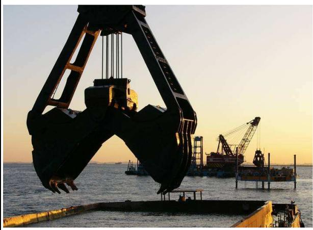
23m<sup>3</sup>級バケット（グラブ浚渫船）。近くで見ると結構デカイ。
