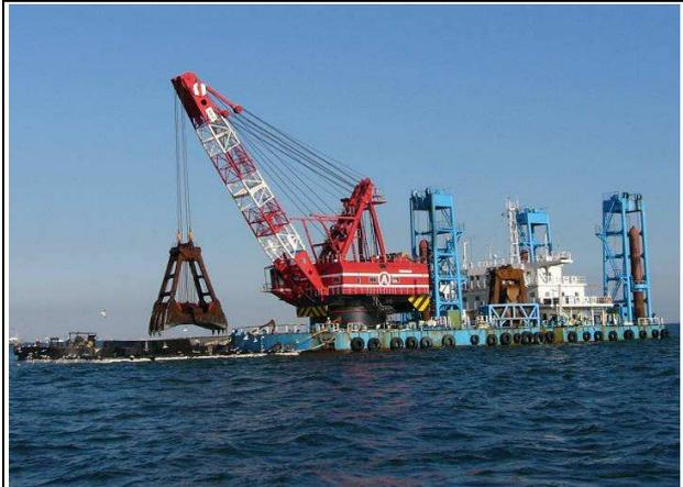
グラブ浚渫船による盛上土撤去です。現在10隻の船が稼働中です。稼働中の浚渫船周辺には、浚渫土に混じっているエサ（生物？）を得ようとするカモメが群がっています。
