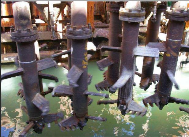
CDM船の混合処理機です。海底地盤に押し込んで、セメントミルクを先端から出し
