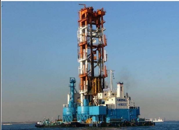
CDM船（セメント系深層混合処理工法）は、セメントミルクの固化材と海底地盤の軟弱土を混合処理機を用いて攪拌・混合し、地盤の強度を得る工法です。この船の船名は、ポコム2号。デコム7号もいます。（ポコ・デコ？）
