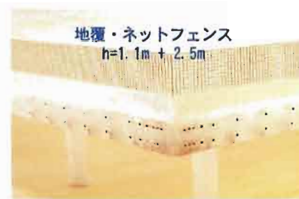
写真-3 地覆・フェンス模型
