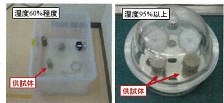
(a) 湿度 60%程度 (b) 湿度 95%以上 写真-1 曝露試験状況
