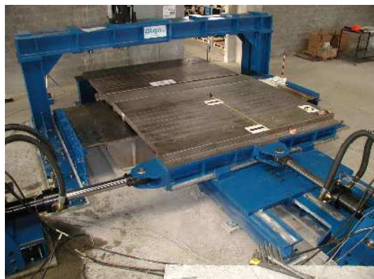
写真-1 R ジョイント試験体
