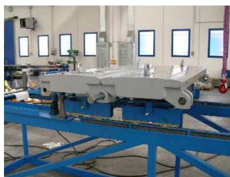
滑り板の組立
