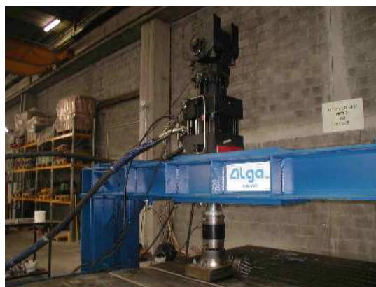
写真-2 静的載荷試験（鉛直載荷）
