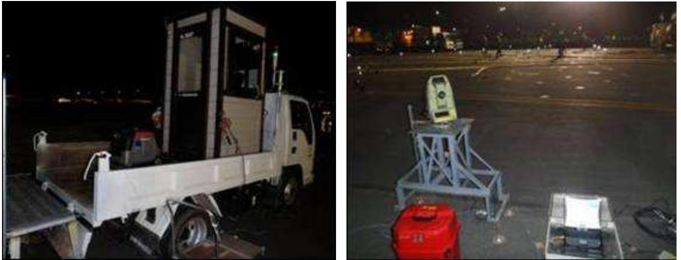
写真-3 自動追尾計測実施状況
