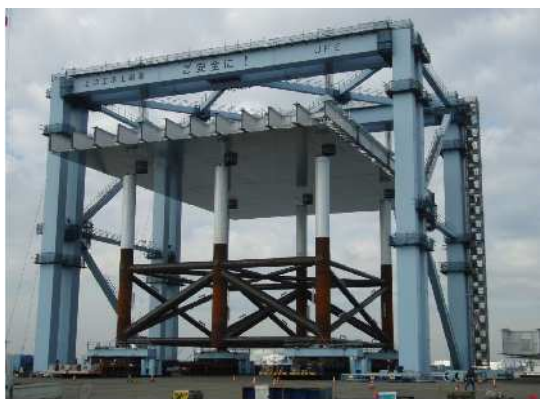
写真—5 上部工吊上げ装置（千葉工場）
