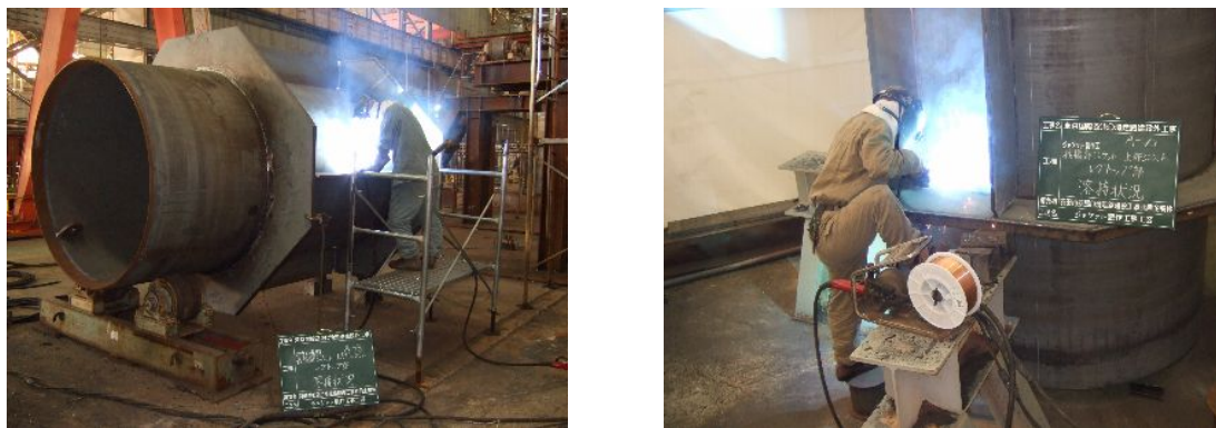
図-6 レグトップの実製作状況
