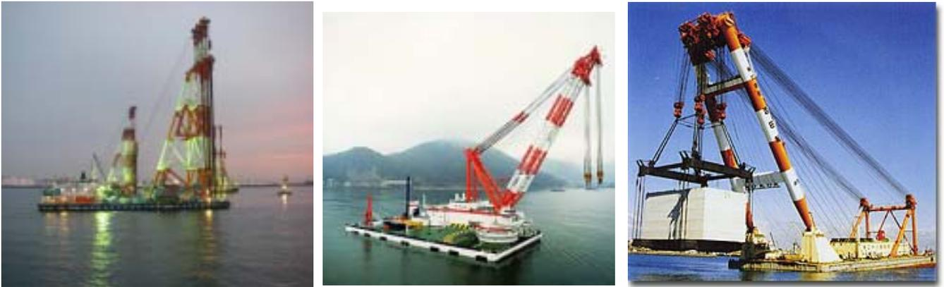
地盤改良船(TP.+60~80m)約13隻 杭打船(最大TP.+122m)約8隻 起重機船(最大TP.+131m)約3隻
