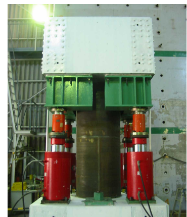
写真-1 載荷装置(引抜き試験)
