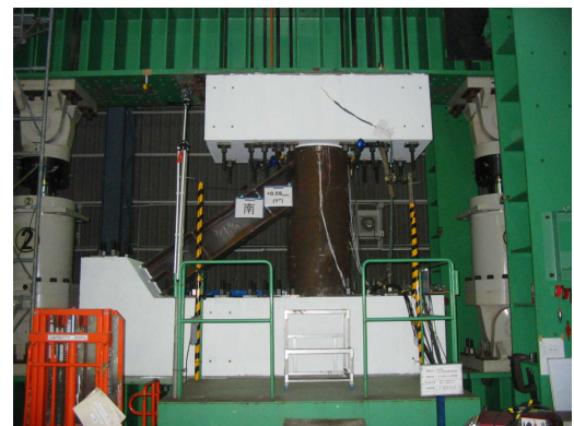
写真-3 載荷状況(ジャケット部水平載荷)
