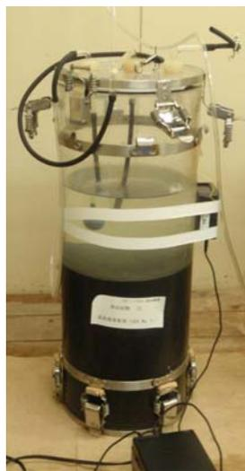
底質調査と同様に海底の泥を採取し、実験室に持ち帰り、泥の入った柱状採泥器に、左図の様な装置を取り付け、一定時間ごとに水中に溶け出す窒素・リン等の量を測ることで、泥からの溶出量を測定しました。
