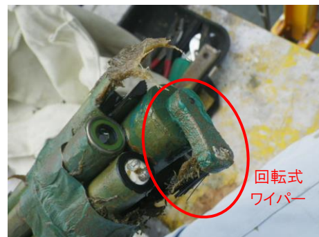
多項目水質計センサー周辺の生物付着状況 (刺胞動物とよばれるクラゲに近い仲間)
