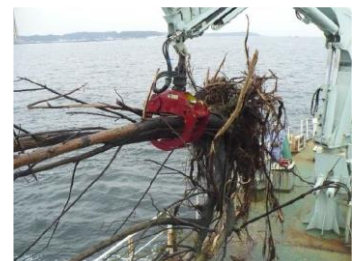
クレーンによる流木の回収
